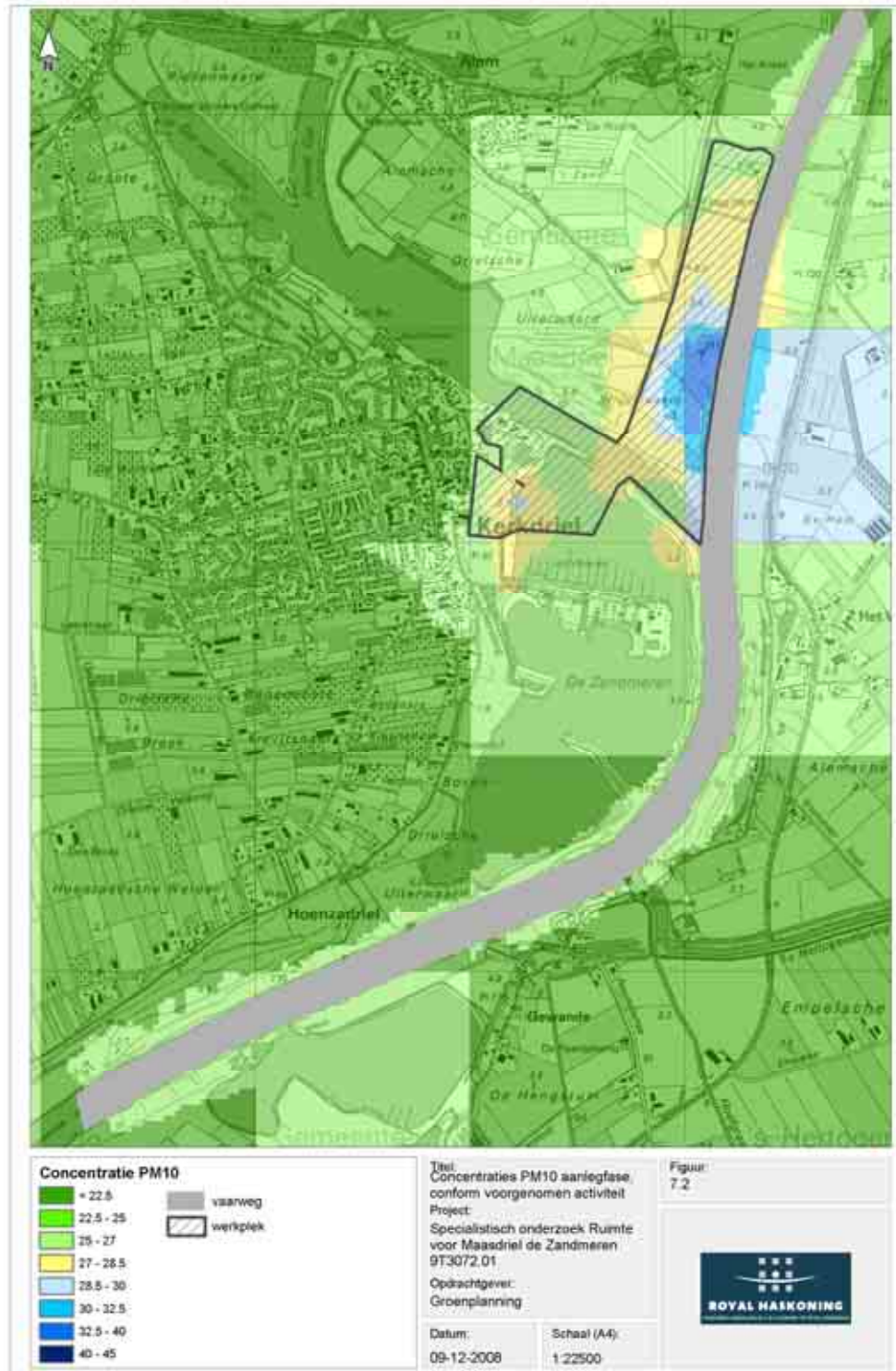
Figuur 7.2 Concentraties PM 10 tijdens de aanlegfase conform Voorgenomen Activiteit
