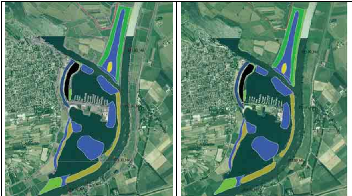
Figuur 5-2 Fase 6 met deels verlaagde oever (links) en volledig verlaagde oever (rechts)
